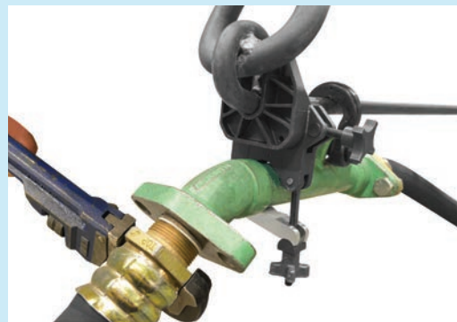
Quitar la manguera de extremo es más fácil cuando el Estabilizador del Tubo del Trole a "manos libres" está sujetado al tubo de la carretilla
