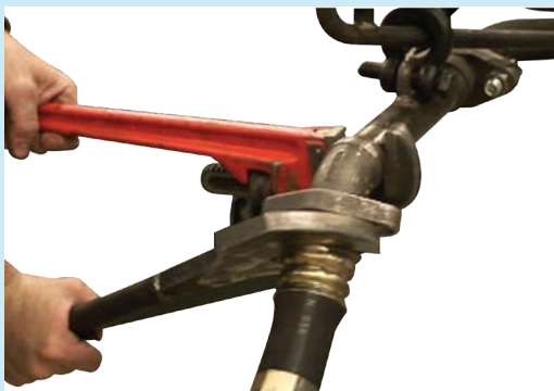
Quitar la manguera de extremo es difícil cuando se usan dos llaves
