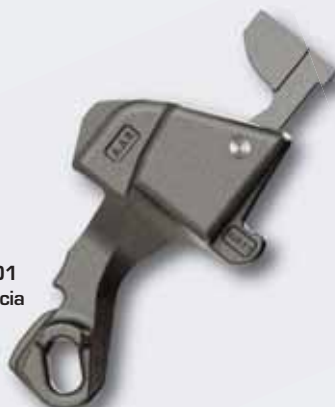
Candado giratorio del Acoplador tipo F
