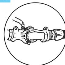
Para quitarla: use la válvulas de descarga en las gladhands de la manguera Run-A-Round para descargar cualquier exceso de aire antes de desconectarla manualmente.
