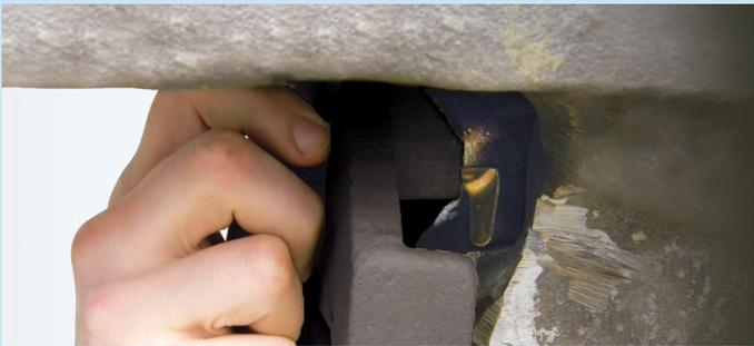
Levantando el brazo horizontal del soporte, incline el soporte hacia atrás y deslícelo hacia la cara tirante del acoplador, de tal forma que la abrazadera de montaje axial pase sobre la Costilla de refuerzo localizada sobre el conjunto locklift. Puede ser necesario mover un poco el tornillo para hacer que la abrazadera pase sobre la costilla.
