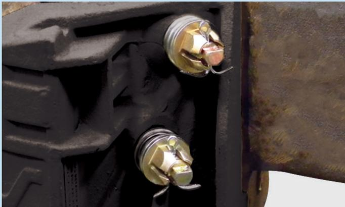
En la abrazadera inferior, inserte el perno en las ranuras de los conjuntos retenedores del resorte de las abrazaderas. Asegúrelos doblando el perno. Repita esto con la abrazadera superior. Por favor ponga atención en cómo se doblan los pernos para evitar accidentes.
