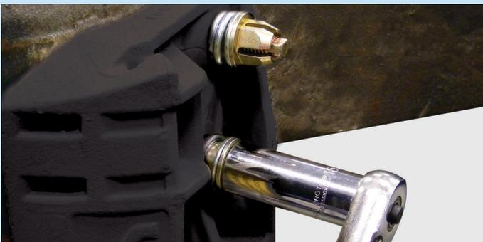
Vuelva a apretar los conjuntos retenedores de resorte superior e inferior hasta que la roldana Belleville queden comprimidas por los retenes.
