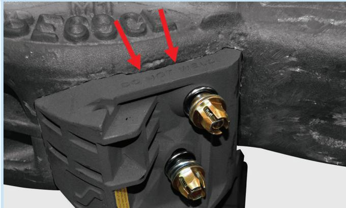
El soporte debe hacer contacto con el contorno exterior del acoplador. Si se instala correctamente, el brazo vertical del soporte deberá estar detrás del cuerno del acoplador.
