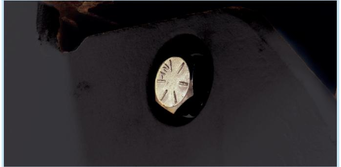
Apriete la abrazadera de montaje axial hasta que la roldana de seguridad se trabe.
