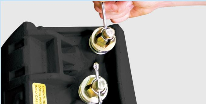
Remueva las chavetas. (Guárdelas para volverse a usar). Si se quitan las roldanas Belleville, asegúrese de volver a colocarlas con la cara cóncava hacia el soporte.
