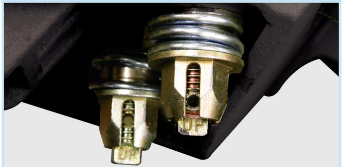
Verifique que las marcas "UP" en ambas abrazaderas superiores e inferiores queden hacia arriba. Probablemente necesite apretar los conjuntos retenedores del resorte un poco más para que los orificios de las chavetas queden alineados con los agujeros de las chavetas en las abrazaderas.
