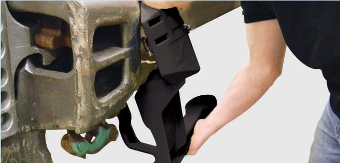
Inserte el soporte de forma angular, de tal manera que la abrazadera superior se deslice por debajo de la orilla superior del agujero aligerador y que la base de descanso del soporte se apoye en la costilla horizontal del acoplador. Asegúrese de que la abrazadera inferior está dentro del agujero aligerador inferior.
