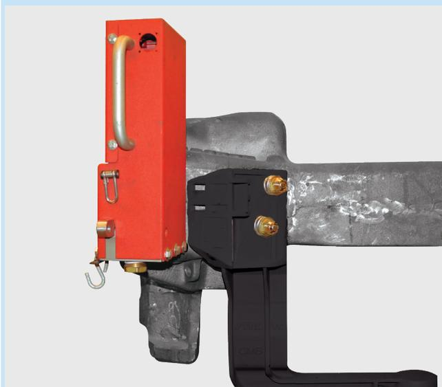
Se instala en los dos agujeros aligeradores frontales y no toca o interfiere con el Soporte Montado en el Acoplador.
