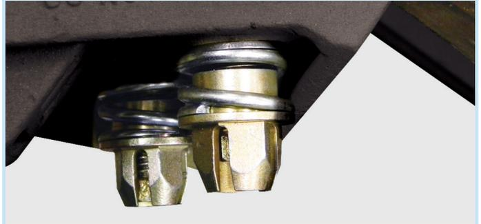
Apriete a mano el conjunto retenedor del resorte en la abrazadera superior (unas cuantas vueltas) para reducir el juego entre el acoplador y el soporte.
