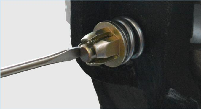
Usando un desarmador plano, empuje la abrazadera inferior dentro del agujero aligerador.
