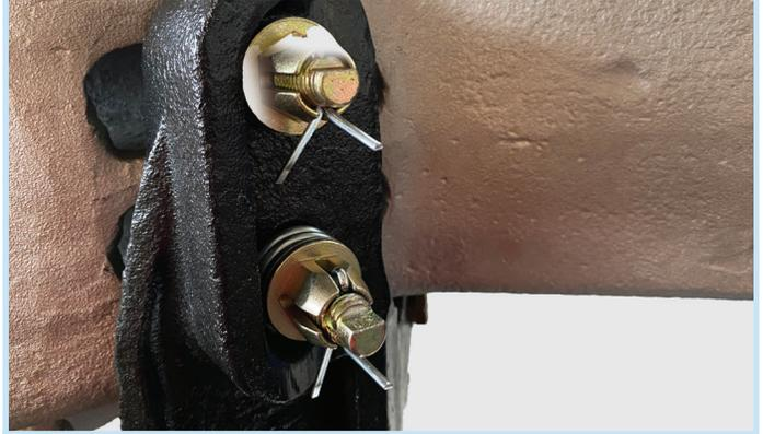
En la abrazadera inferior, inserte el perno en las ranuras de los conjuntos retenedores del resorte de las abrazaderas. Asegúrelos doblando el perno. Repita esto con la abrazadera superior. Por favor ponga atención en cómo se doblan los pernos para evitar accidentes.
