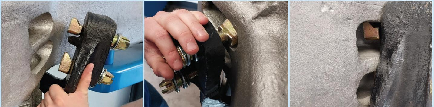
Empezando desde el gancho inferior del tornillo superior, inserte el soporte en un ángulo tal que la abrazadera superior se deslice por debajo de la orilla superior del agujero aligerador y la superficie de apoyo del soporte asiente en la costilla horizontal principal del acoplador. Asegúrese que la abrazadera inferior está en el agujero aligerador inferior.
