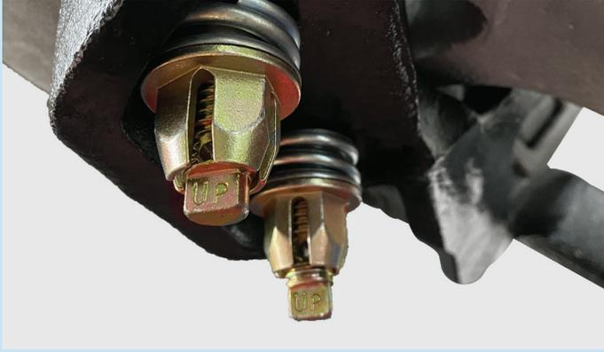
Verifique que las marcas "UP" en ambas abrazaderas superiores e inferiores queden hacia arriba. Probablemente necesite apretar los conjuntos retenedores del resorte un poco más para que los orificios de las chavetas queden alineados con los agujeros de las chavetas en las abrazaderas.
