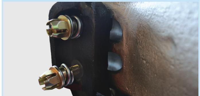
Afloje el conjunto retenedor del resorte de la abrazadera inferior hasta el extremo de la cuerda.
