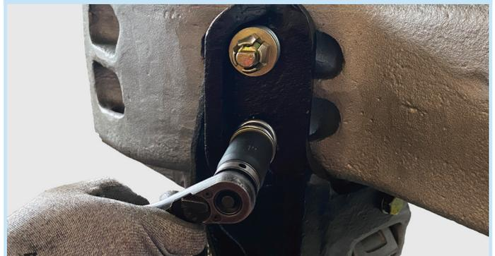
Vuelva a apretar los conjuntos retenedores de resorte superior e inferior hasta que la roldana Belleville queden comprimidas por los retenes.
