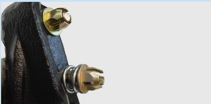
Apriete a mano el conjunto retenedor del resorte en la abrazadera superior (unas cuantas vueltas) para reducir el juego entre el acoplador y el soporte.
