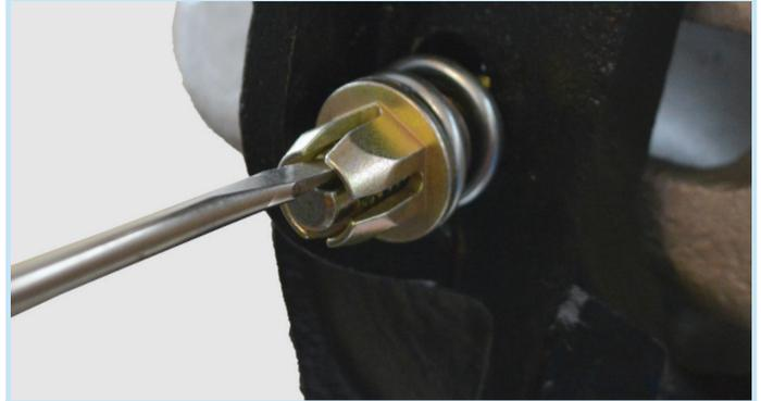
Gire la abrazadera 90° con el desarmador hasta que el lado plano del tornillo marcado "UP" quede hacia arriba.
