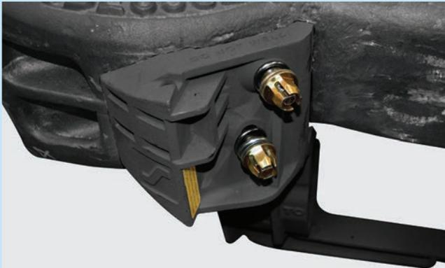
El Soporte Montado en el Acoplador tiene ranuras especiales para montar el AFT directamente en el soporte.
