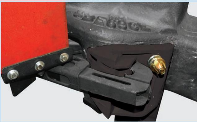
El AFT se monta directamente al Soporte Montado en el Acoplador para tener una conexión segura y un alineamiento correcto.
