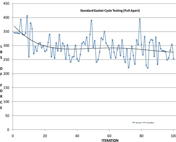
**FIGURE 1: STANDARD GASKET CYCLE TESTING**
