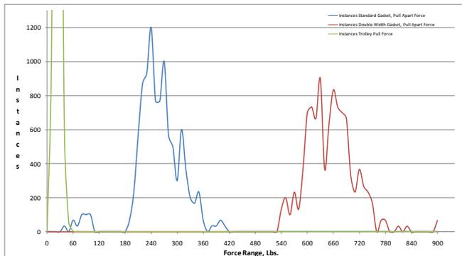
**FIGURE 10: INSTANCES OF SEPARATION FORCE REQUIRED**
